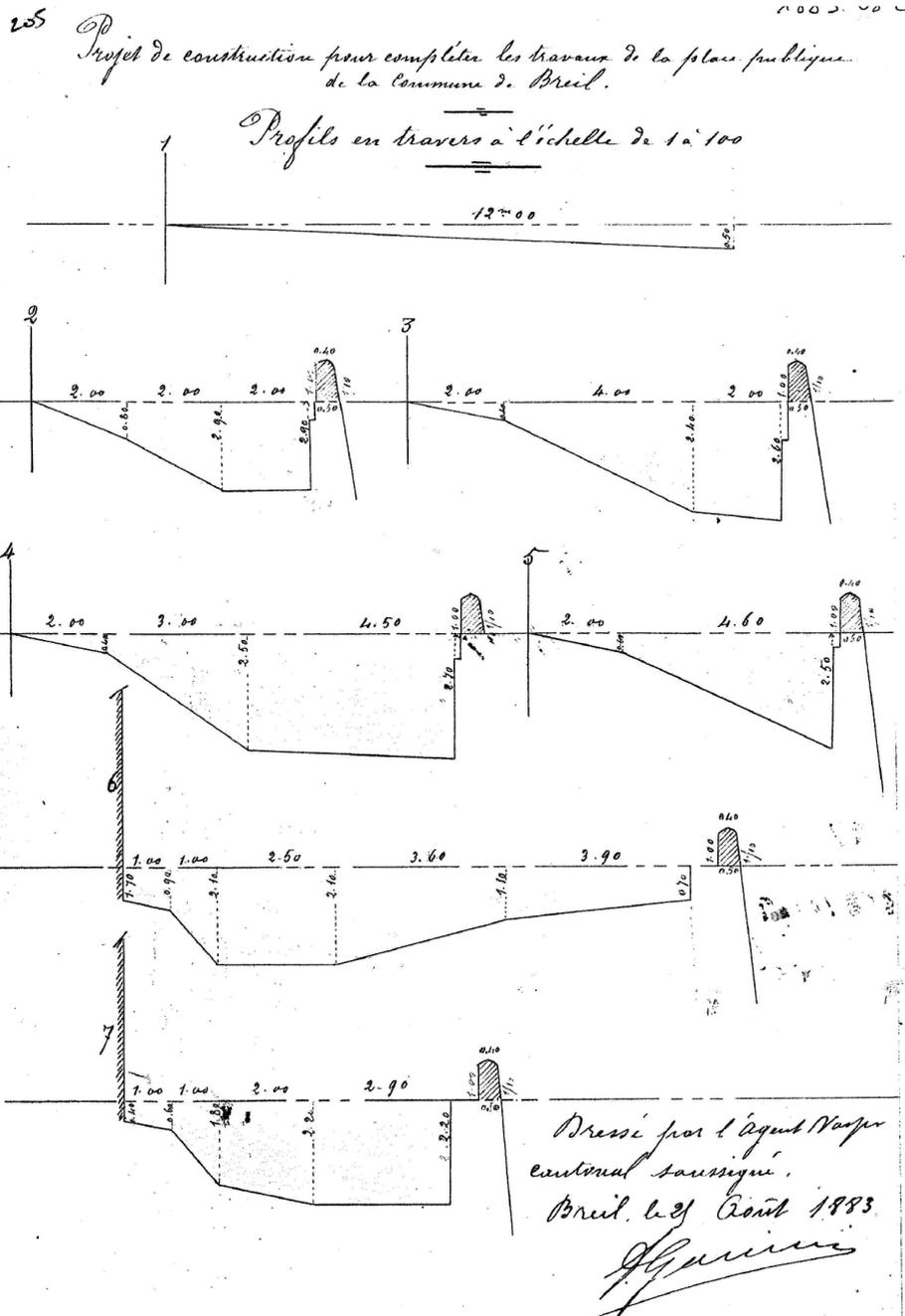
Figure 20. Profils en travers des remblais à réaliser en 1883. (Archives communales / ADAM)
