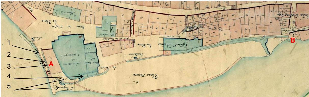
Figure 22. Extrait du cadastre de 1864 montrant les deux places, le mur de 1854 et le canal des moulins du sud. Les parties enterrées des canaux ne sont pas représentées. (A : moulin Cachiardi. B : moulin Toesca et Boeri). (Document ADAM)
