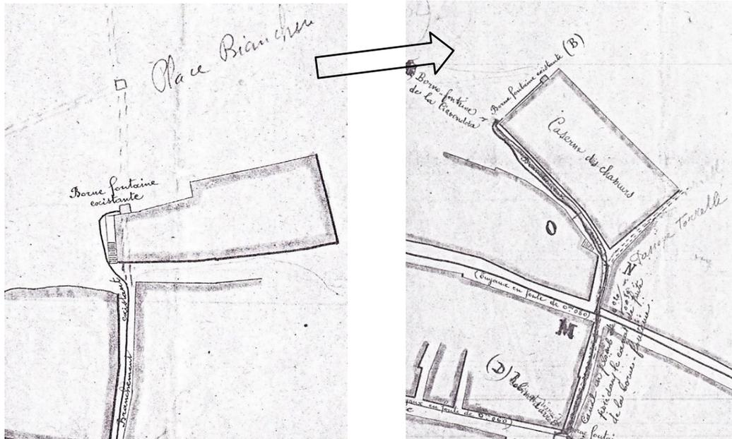
Figure 29. Détail du plan de 1896 pour le couréou da Banca. On y voit le drain (double ligne pointillée) de la ruelle, qui passe sous le bâtiment (actuel E 153, restaurant Le Biancheri), et dans lequel l'évacuation de la borne fontaine se faisait vraisemblablement. (Plan ingénieur Bourgougnon / ADAM)
