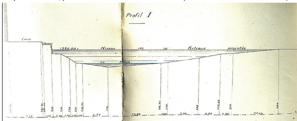
Figure 38. Profil I sur la Roya vers 1926 (face à la ruelle au sud de la chapelle de la Miséricorde, voir figure 24), Extrait du « Plan de la Roya en amont de la retenue », avec localisation du niveau d'eau initial de la rivière et du niveau de la retenue. (Archives communales aux ADAM)
