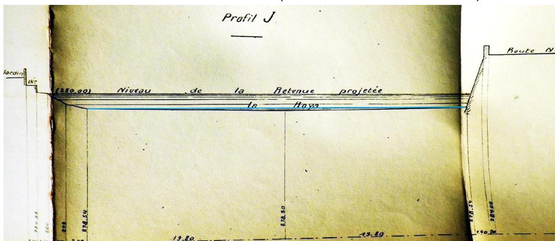
Figure 39. Profil J sur la Roya vers 1926 (face à la Poste actuelle, voir figure 24), Extrait du « Plan de la Roya en amont de la retenue », avec localisation du niveau d'eau initial et du niveau de la retenue. (Archives communales aux ADAM)
