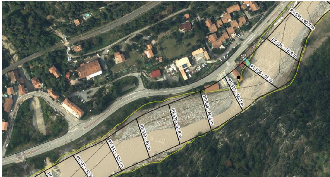
Figure 125 : Illustration d'un lit d'une soixantaine de mètres préconisé sur la Roya en amont de Breil-sur-Roya
