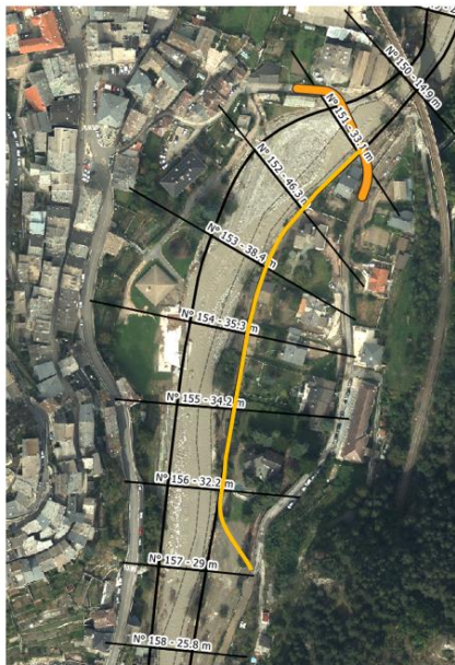
Figure 129 : Paramètres hydrauliques au niveau du profil en travers 153. Possibilité de protéger pour le scénario centennal, par une protection de berge, sous réserve de remblayer le terrain naturel
