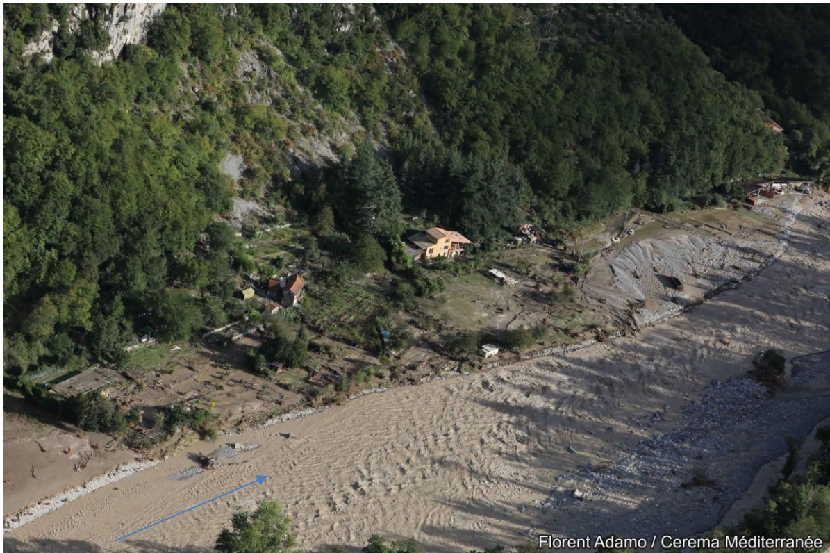
▲ Photo 88 : Roya au droit du stade de football (détruit). 4 bâtiments détruits en rive gauche et pont d'accès détruit. Vue amont -> aval. Cliché : F. ADAMO, CEREMA. Localisation : cf. Figure 104, réf. P6
