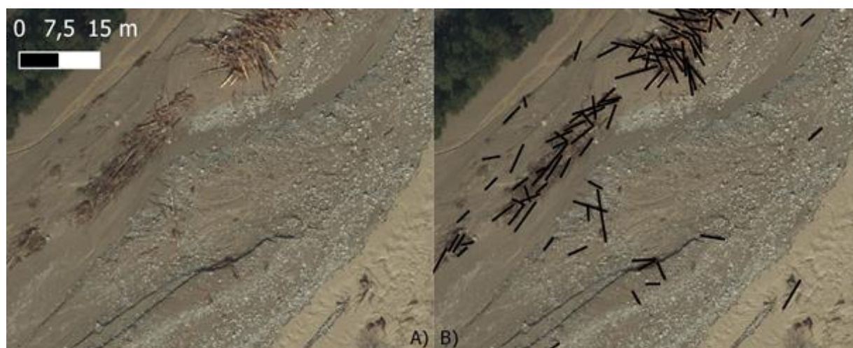
Figure 112 : Exemple de dépôts d'embâcles sur les orthophotos d'urgence : A) image brute et B) exemple des embâcles digitalisés
