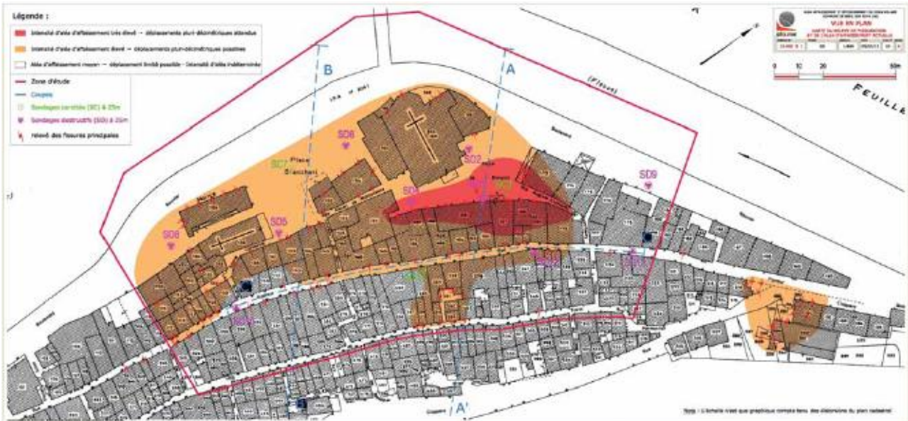
Figure 53. Estimation de l'emprise des tassements de sol en 2012, selon Géolithe. (Nota : la carte ne représente pas la réalité des tassements visibles ou documentés)
