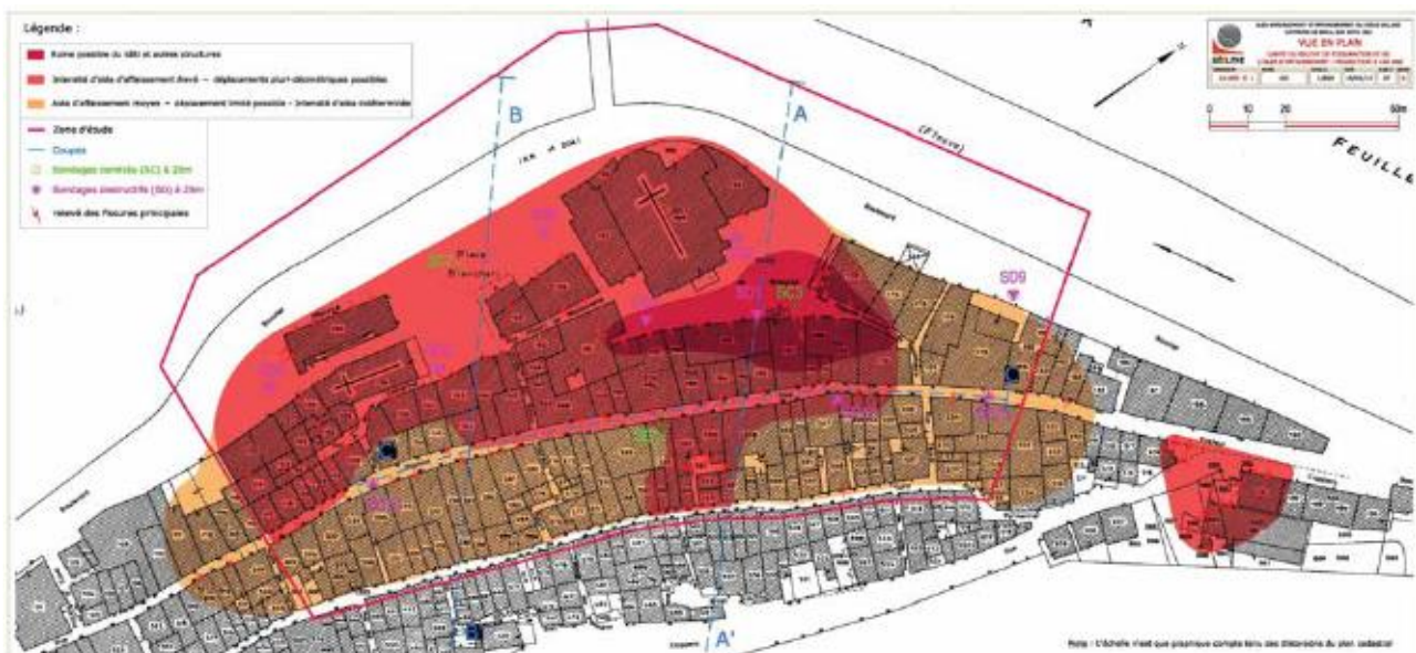
Figure 54. Evolution supposée des tassements de sol en 100 ans si rien n'est fait, selon Géolithe. La carte ne s'appuie pas sur des analyses hydrogéologiques.
