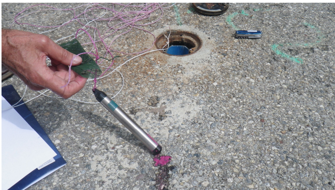
Fluocapteur en FE2 coloré par la sulforhodamine injectée en FE1bis
