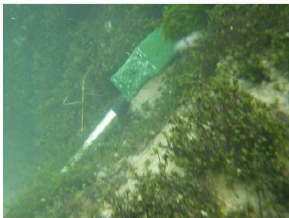
Fluocapteur (avec sonde Solinst) en Roya
