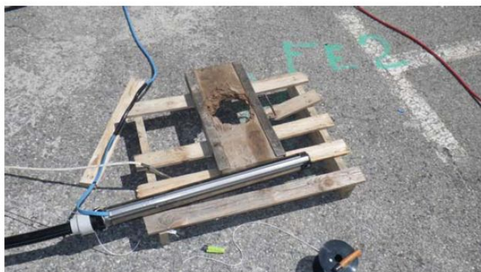
Pompe (débit nominal 2 m 3 /h à 25 m)
