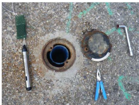
Fluocapteur (avec sonde Solinst) dans certains forages
